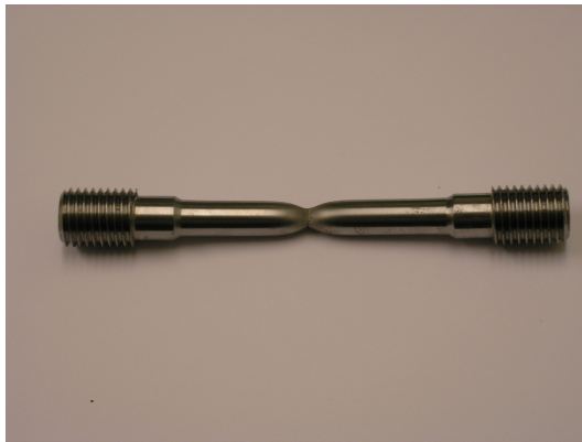
Figuur 5.2: Een metalen buis met een nek die ontstaan is doordat er teveel kracht op de buis stond.
