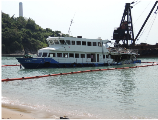
Figuur 5.1: De gehavende Lamma IV na de botsing.
